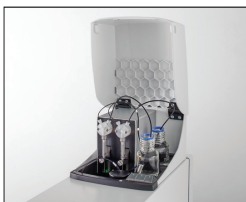
选配分液器模块，用于快速动力学、瞬时发光和双重加样等检测。
