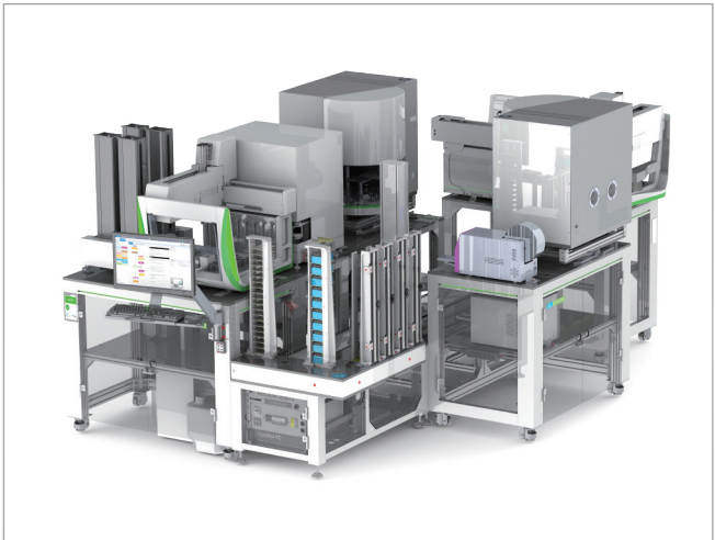
图6. JANUS 自动化液体处理平台，可非常方便整合到超高通量机器人系统，如 Cell::Explorer 系统，致力于定制型的生物学应用。
