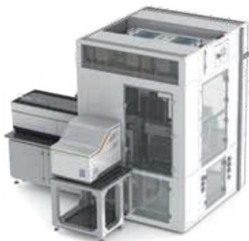
此 explorer G3 系统中通过 plate::handler Flex 机械手整合 Janus 自动化液体工作站,自动化的细胞培养箱,IQue 流式细胞仪以及 Opera Phenix 高内涵分析,可高通量构建和筛选细胞系,以及靶点的药物筛选,应用于免疫药物研发,细胞系构建,靶点验证以及高通量的高内涵分析与高通量药物筛选等领域。
