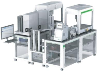
此 explorer G3 系统中通过 plate::handler Flex 机械臂整合 Janus 自动化液体工作站，Sciclone G3 文库制备工作站，Labchip GX Touch 文库质控，酶标仪，PCR 仪等，实现 NGS 文库制备与质控全流程自动化。
