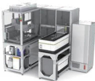
此 explorer G3 系统中通过 plate::handler Flex 机械手整合 Janus 自动化液体工作站,自动化的细胞培养箱,自动化储板栈以及 Opera Phenix 高内涵分析,构建自动化的高内涵筛选平台,可用于高通量的细胞表型筛选,细胞靶点验证,高通量基于 3D 细胞筛选,细胞系构建等应用。
