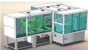
此 explorer G3 系统利用机械臂整合了 JANUS 工作站、chemagic 360 核酸提取仪，Labchip 核酸检测仪和 QPCR 仪，实现全自动化 DNA 提取，DNA 浓度测序及浓度均一化，PCR Setup 和在线 QPCR 扩增。
