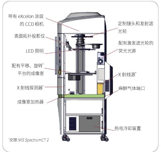
图 1: IVIS Spectrum 2 平台内部
