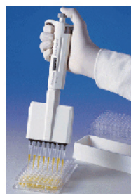
将样本和试剂 加入到96孔板中
