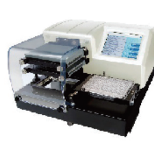
通过洗板机进行 磁珠的自动清洗
