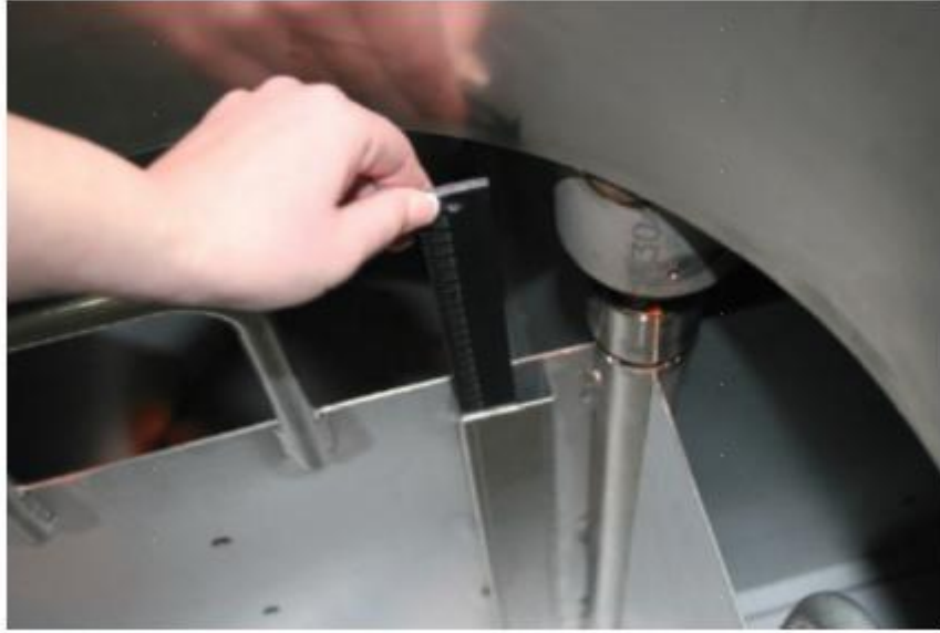
插入液位液氮标尺测量液氮的物理液位
