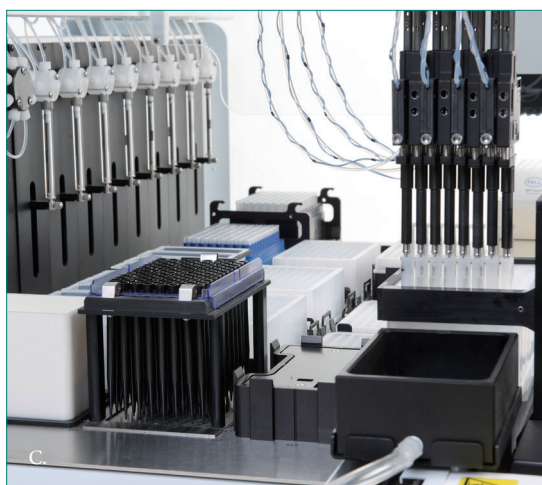
JANUS G3 BioTx系列工作站兼容 Phynexus PhyTips®带填料吸头(A)、过滤板(B)和 RoboColumns®层析柱(C)。纯化方法包括亲和、离子交换、反相和凝胶过滤。
