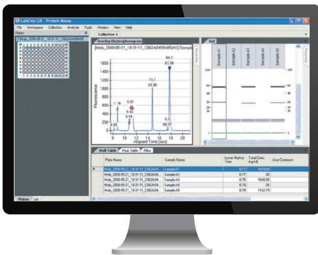
图11 . LabChip GXII Touch系统在运行过程中提供实时数据输出，以及完整的数据分析
